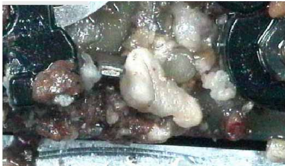
スラッジが発生し詰まってしまったインジェクターポンプ 出典:日本自動車工業会資料より抜粋
