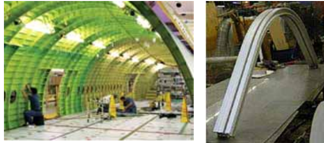
図 4-1-2 チタン押出／鍛造材例（胴体フレーム）
