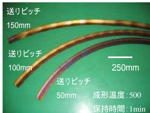
図3-1-2-16 成形試験結果（供試体全体形状）
