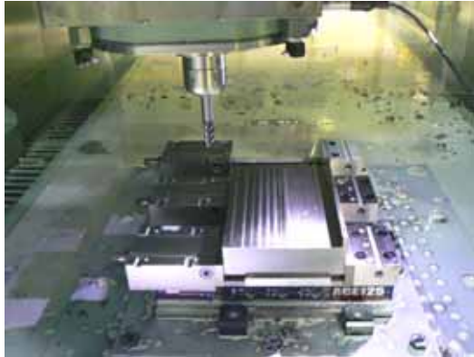
図 3-1-2-17 刃具及び供試材料セット状況 図 3-1-2-18 切削速度と刃具寿命時間の関係 (200 μm 磨耗)
