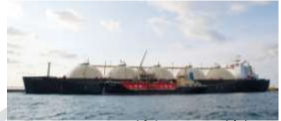
STS(LNG外航船から内航船へ)
