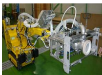
高圧水除染装置
