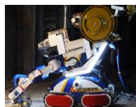
吸引・プラスト除染装置
