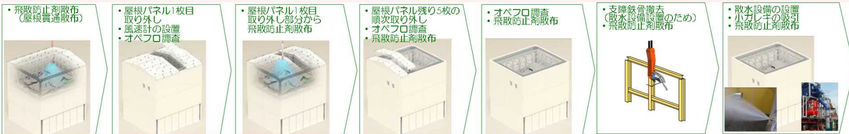
建屋カバー解体の流れ（至近の工程）
