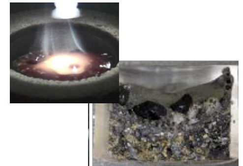
炉心材料とコンクリートの溶融反応
