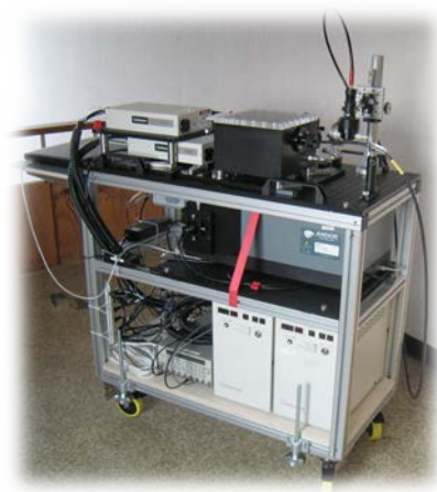
可搬型水中伝送LIBS装置 (試作)
