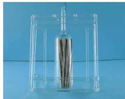
図2 ガス発生試験のイメージと金属腐食速度の例
