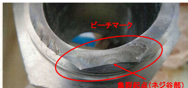
継手の破断面
