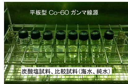
炭酸塩試料のガンマ線照射の様子
