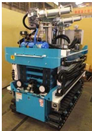
高所用ドライアイスブラスト 除染装置
