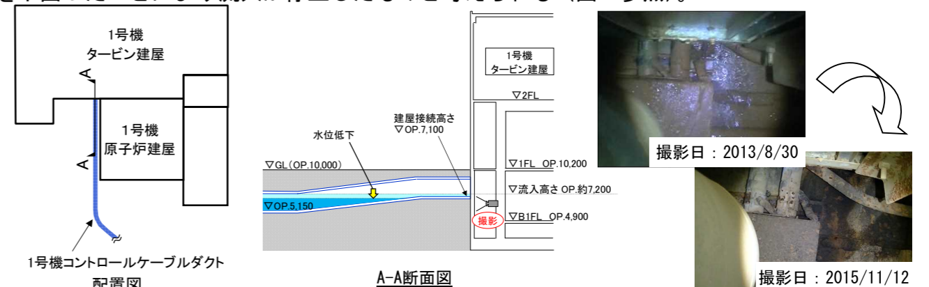
図1：1号機コントロールケーブルダクト接続部 地下水流入状況
