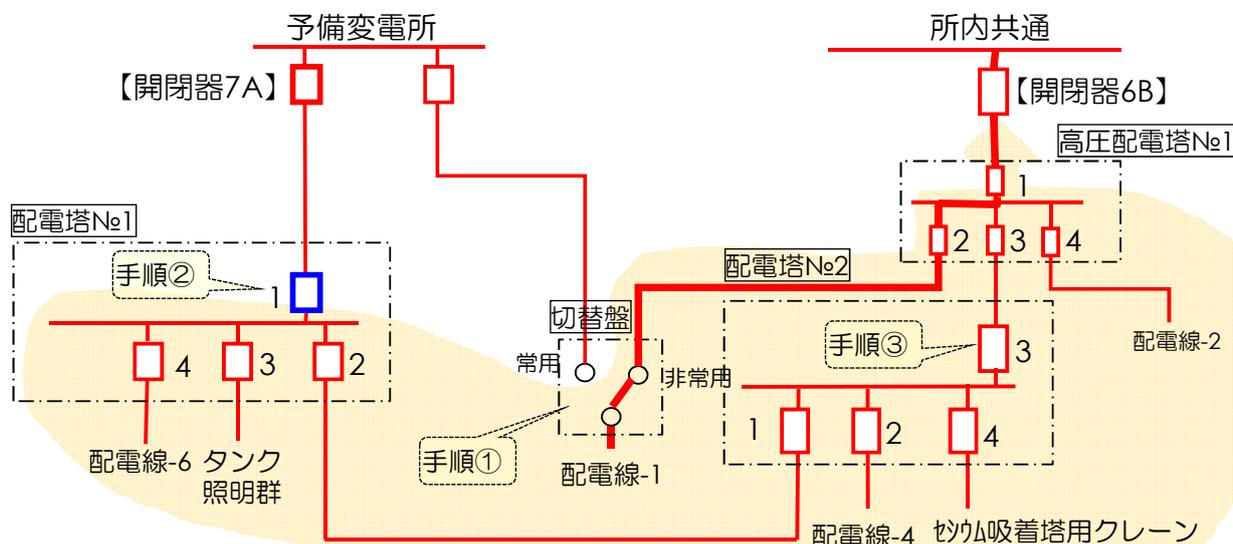
(凡例) 赤線：充電中の回路状態を示す 青線：開放中の回路状態を示す 黄色：充電部
