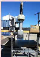
塗装剥離試験の様子
