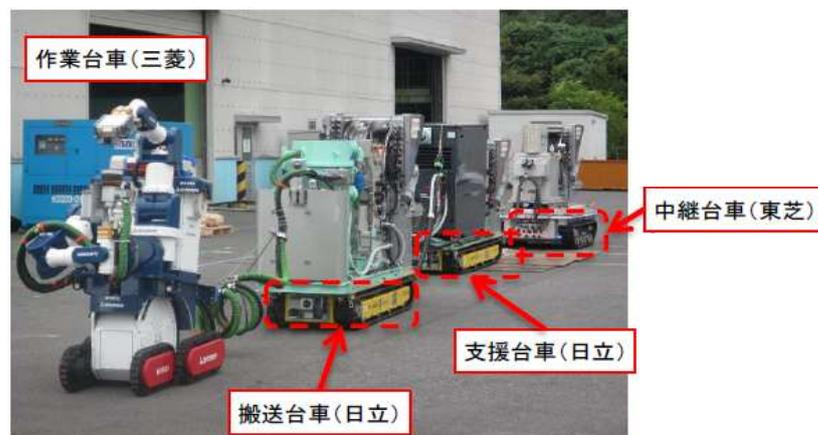
図 4.3.2-20 高所用・上部階用除染装置 (IRID 提供)
