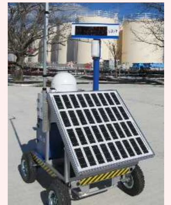
線量率モニタの設置状況
