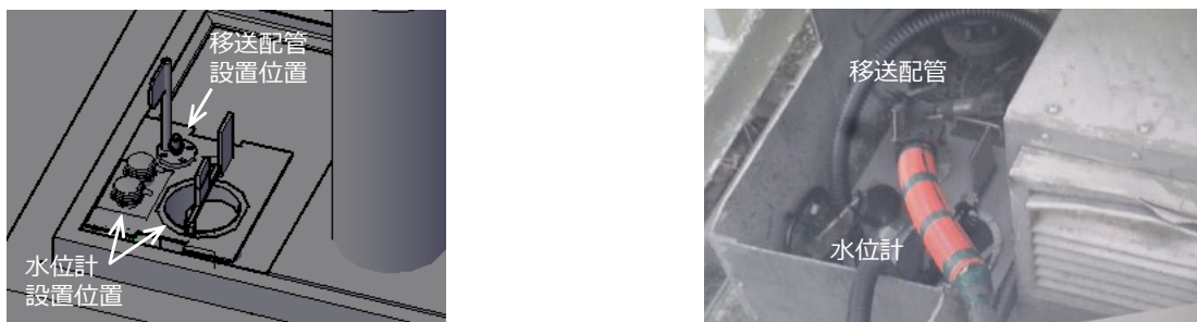
水位計および移送配管設置計画図
