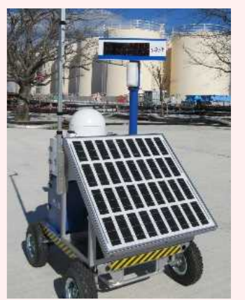
線量率モニタの設置状況
