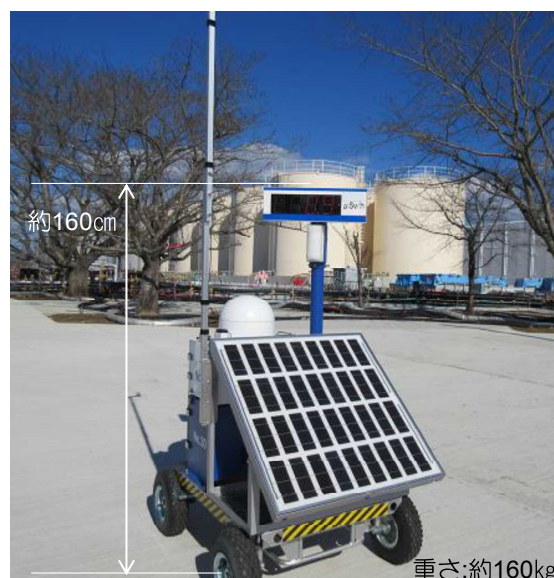
線量率モニタ 外観写真
