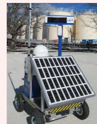
線量率モニタの設置状況
