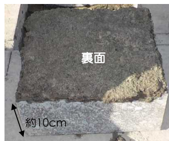
切り出したアスファルト
