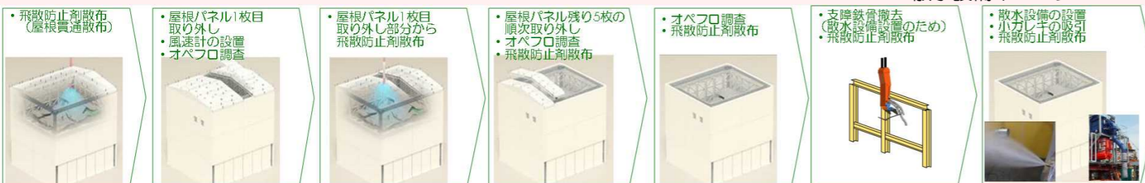
建屋カバー解体の流れ（至近の工程）
