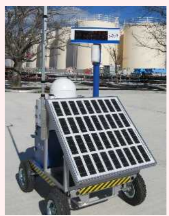
線量率モニタの設置状況
