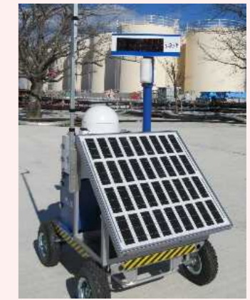
線量率モニタの設置状況
