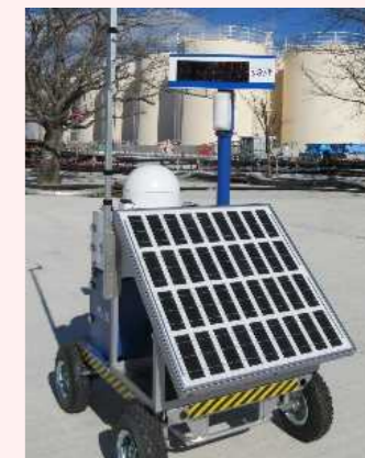
線量率モニタの設置状況
