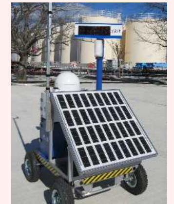
線量率モニタの設置状況
