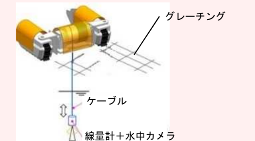
線量計、カメラ吊り降ろしイメージ
