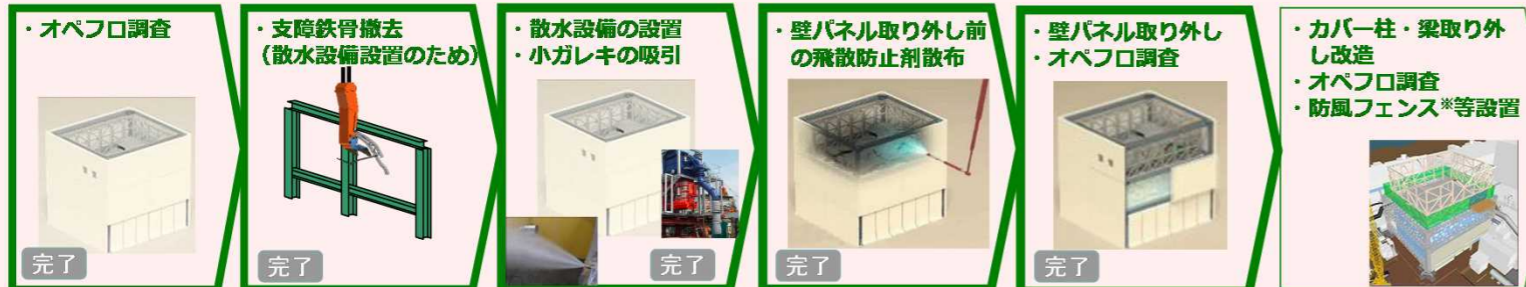
建屋カバー解体の流れ(至近の工程)
