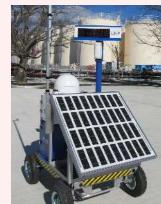
線量率モニタの設置状況
