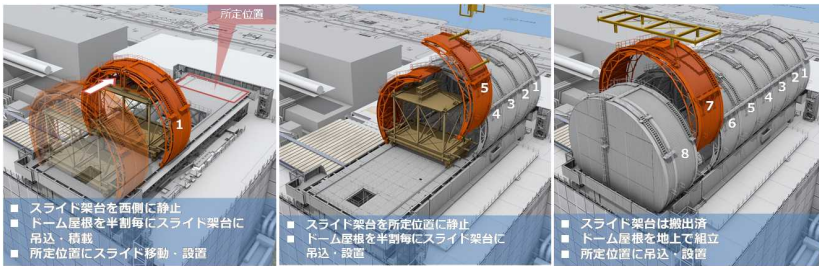
ドーム屋根設置作業イメージ （左：ドーム屋根1 中央：ドーム屋根5 右：ドーム屋根7）
