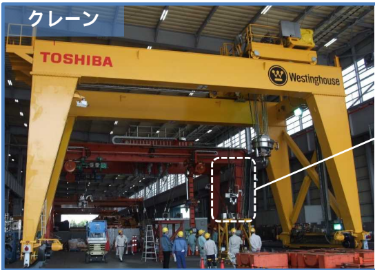
燃料取扱機・クレーンの動作確認状況 （撮影日：燃料取扱機2017年9月12日 クレーン2017年9月14日）
