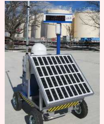
線量率モニタの設置状況
