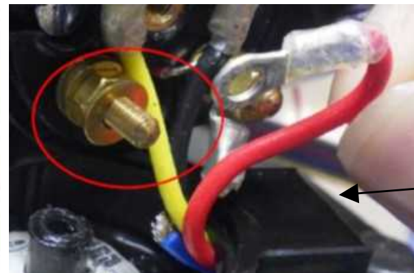
青リード端子の破損状況写真
