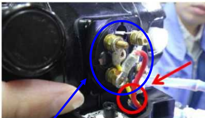
青リード端子の破損状況写真
