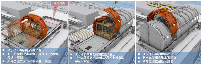
ドーム屋根設置作業イメージ （左：ドーム屋根1 中央：ドーム屋根5 右：ドーム屋根7）
