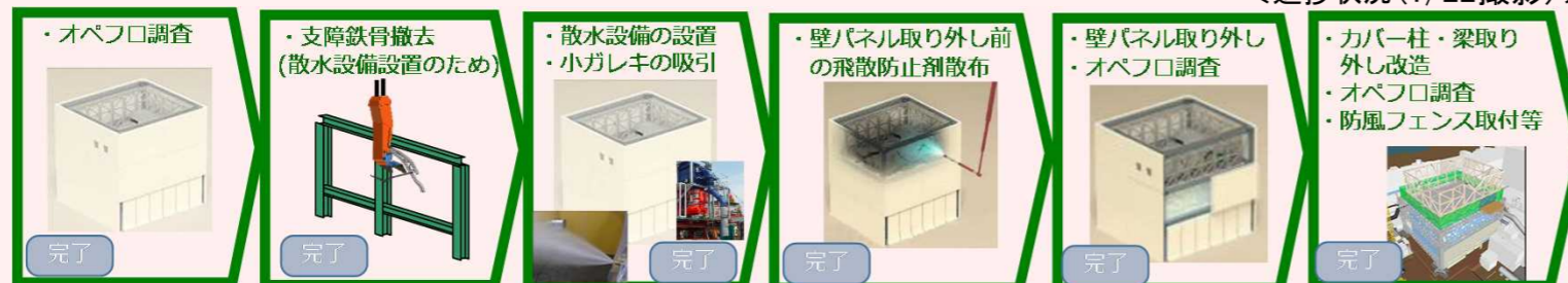
建屋カバー解体の流れ(至近の工程)
