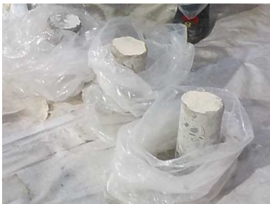
調査用コア採取状況
