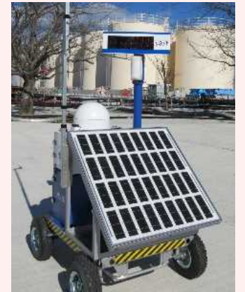
線量率モニタの設置状況
