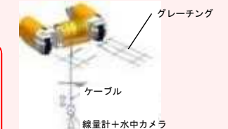
線量計、カメラ吊り降ろしイメージ
