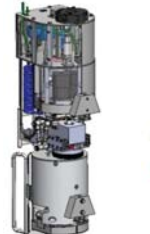
図4 サンプル回収装置 (フレキブルグリッパタイプ)
