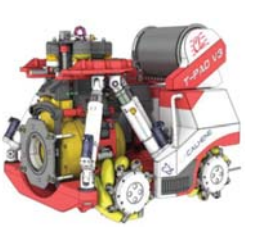
図5 燃料デブリ収納容器 の遠隔輸送台車
