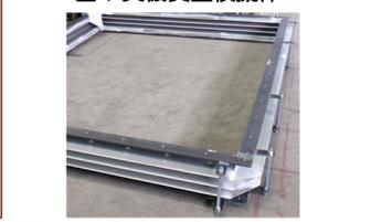
図6 変位吸収機構試験体(ペローズ部)
