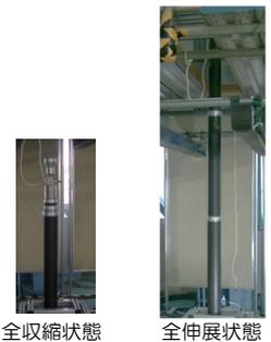
図3 3段テレスコピックによる簡易試験
