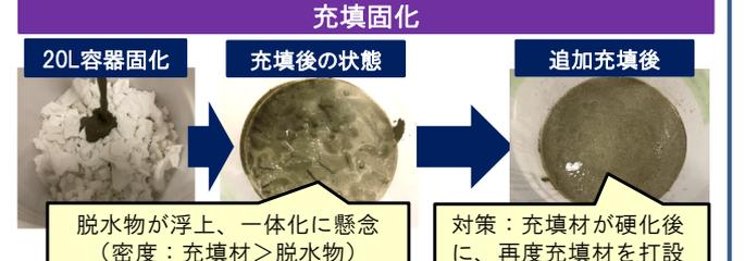
図2 セメントによるALPSスラリー脱水物（塊状模擬物）の充填固化試験の様子
