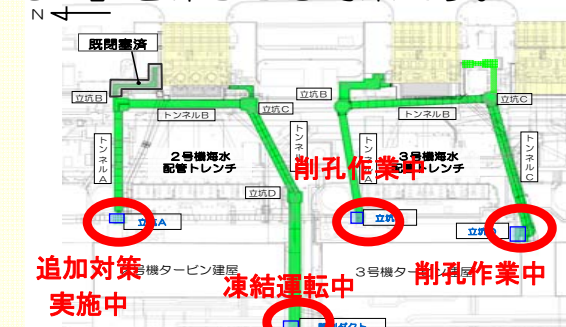
<トレンチ凍結止水 全体状況>
