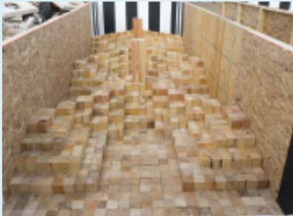
図2：ステップフィールドの試験設備
