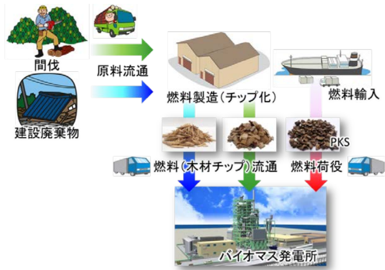
図 29 : 福島県におけるバイオマスボイラ発電事業例
