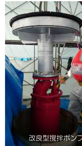
薬剤を投入した後、ポンプを上下させて鋼管壁に地下水を噴射することで洗浄する
