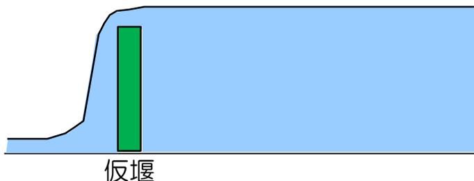
増水で排水量がポンプの容量を上回り、堰内水位が堰高を上回って溢れる状態。
