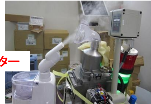
結露模擬試験風景
