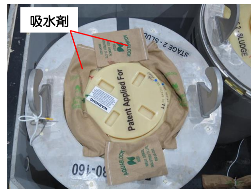
(b) 吸水剤の設置状況
