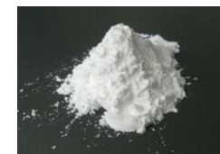
図2 捕集材の例(ゼオライトA)
