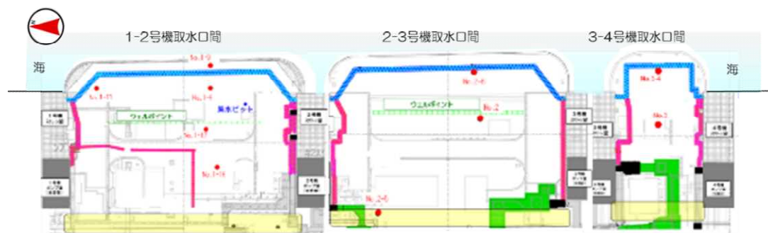
水ガラスによる地盤改良施工箇所
