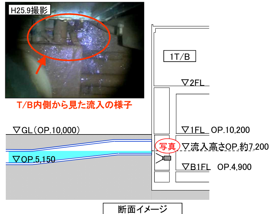
1号コントロールケーブルダクトからの地下水流入状況
