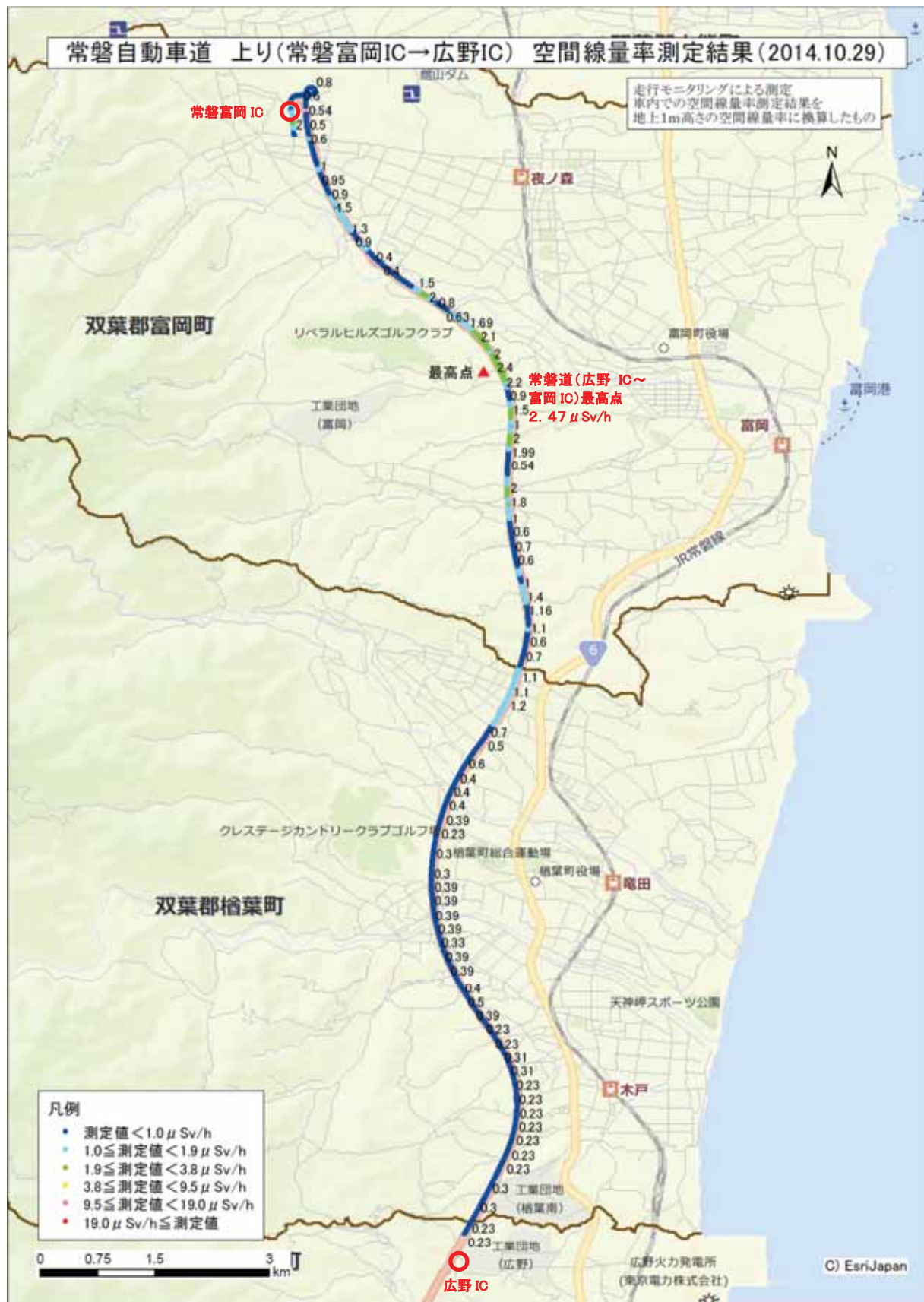
図2-2 モニタリングカーによる測定結果から算出した道路上の車外の空間線量率(上り)
