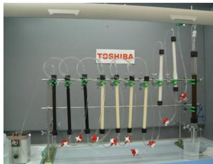
図 試験装置（吸着材充填済）
