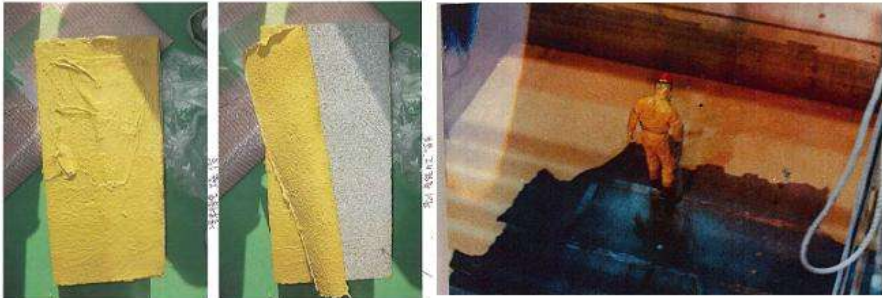
塗料の塗布、剥離状況
