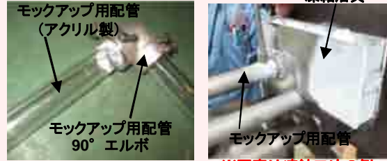
配管挿入試験 モックアップ試験の様子 配管改造工法試験
