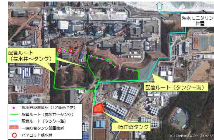
図1：地下水バイパス設備概要
